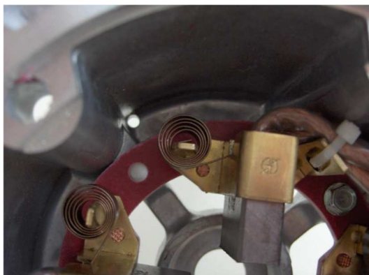
Fig.7 : Système Balais et porte balais d'une machine à courant continu
